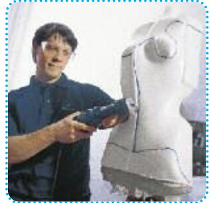
Nach **Erstellung des Modells** geht es in diesem Fall um die Endformung eines Korsetts vom Gips-Positiv.
